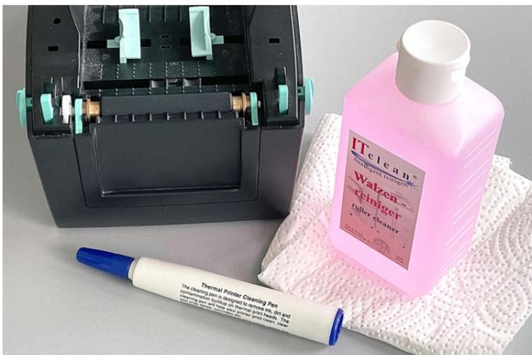
**Abb.3:** Reinigungs- und Pflegeprodukte für Thermotransfer-Etikettendrucker von eXtra4 Labelling Systems
